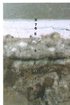
12. Przekrój poprzeczny próbki z klatki schodowej
