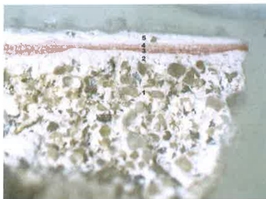
9. Przekrój poprzeczny próbki ze ściany północnej. 1 - tynk, 2 - pobiała, 3,4 - oryginalne warstwy malarskie, 5 - warstwa wtórna
