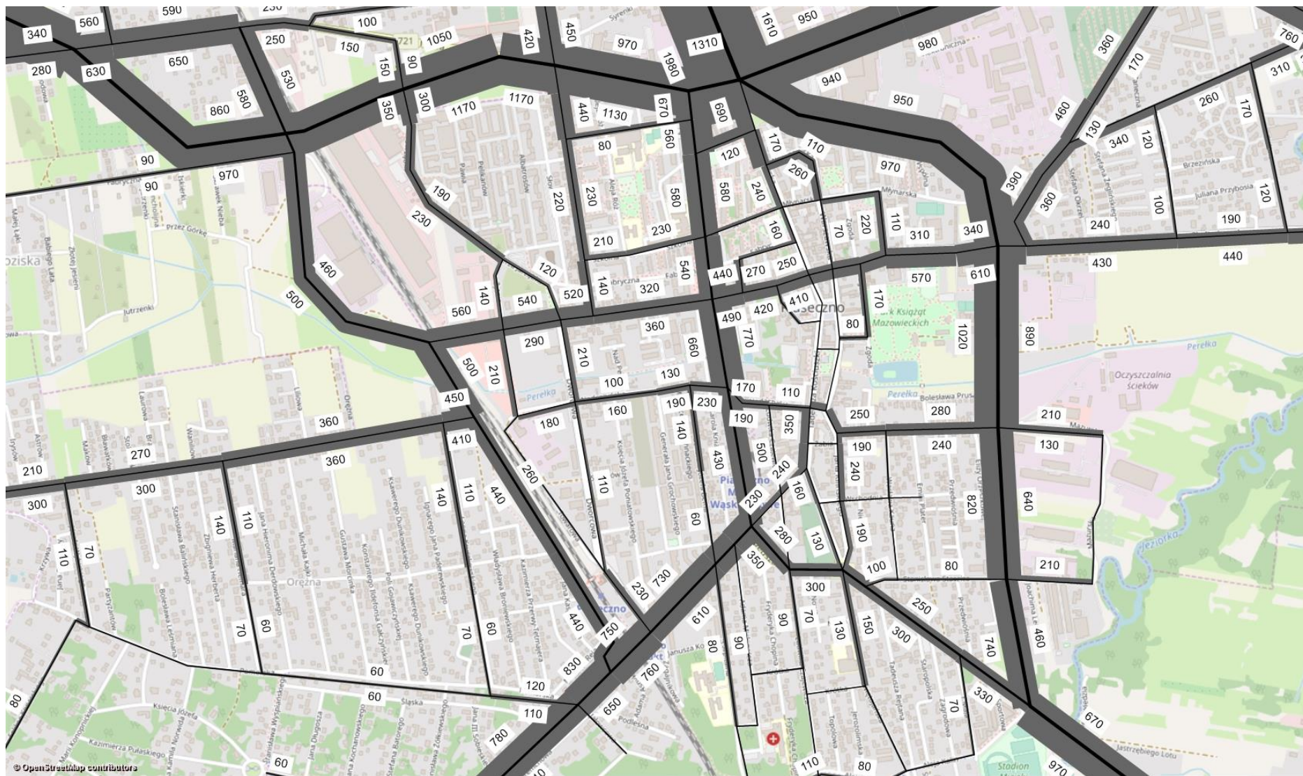
Rys. 8.47. Rozkład ruchu pojazdów w śródmieściu Piaseczna wariant 6b rozwoju układu drogowego w roku 2030 w godzinie szczytu popołudniowego(źródło: opracowanie własne, tło: © autorzy OpenStreetMap).
