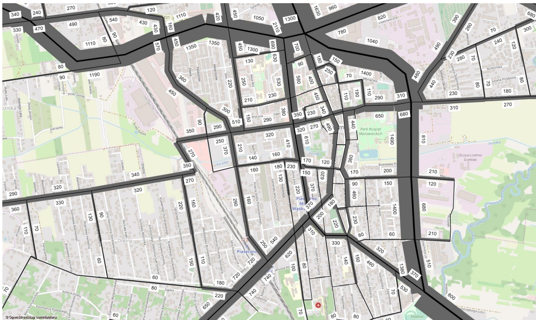
Rys. 8.11. Rozkład ruchu pojazdów w śródmieściu Piaseczna wariant 2 rozwoju układu drogowego w roku 2030 w godzinie szczytu popołudniowego (źródło: opracowanie własne, tło: © autorzy OpenStreetMap).
