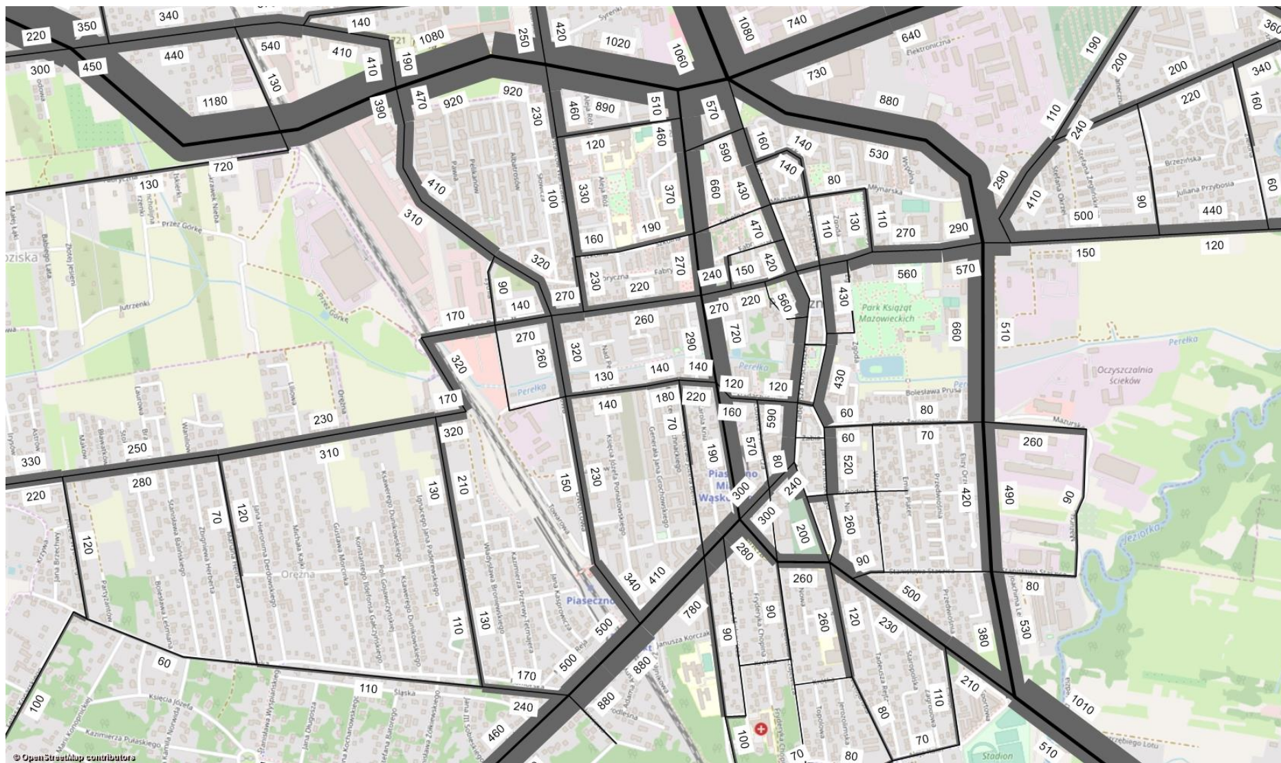
Rys. 8.1. Rozkład ruchu pojazdów w śródmieściu Piaseczna wariant 1 rozwoju układu drogowego w roku 2030 w godzinie szczytu porannego (źródło: opracowanie własne, tło: © autorzy OpenStreetMap).
