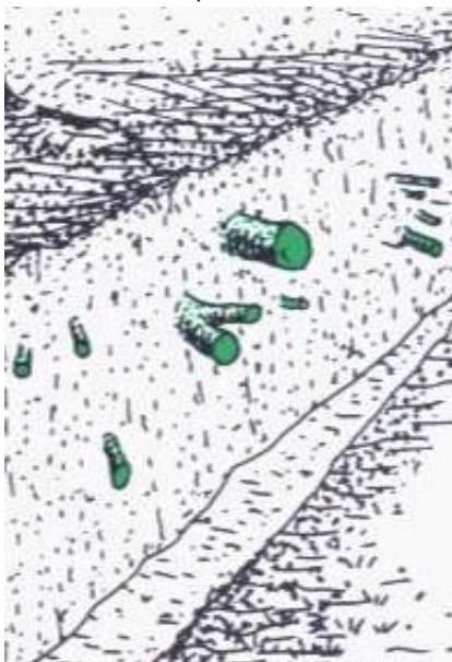
Rys. 5 Postępowanie z korzeniami uszkodzonymi w wykopach. Przycięcie korzeni i zabezpieczenie środkiem do pielęgnowania ran. (rys. pochodzi z European Treeworker, wyd. European Arbicultural Council )
