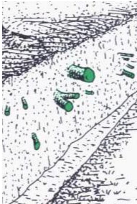
Ryc. 8 Postępowanie z korzeniami uszkodzonymi w wykopach. Przycięcie korzeni i zabezpieczenie środkiem do pielęgnowania ran. (rys. pochodzi z European Treeworker, wyd. European Arbicultural Council )
