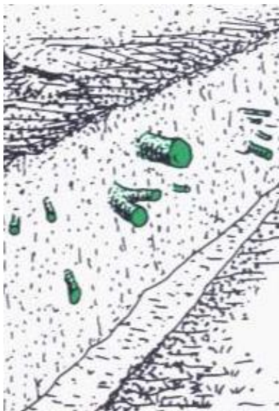
Ryc. 5 Postępowanie z korzeniami uszkodzonymi w wykopach. Przycięcie korzeni i zabezpieczenie środkiem do pielęgnowania ran. (rys. pochodzi z European Treeworker, wyd. European Arbicultural Council )
