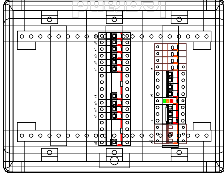
Obudowa natynkowa, 3x18 moduły, metalowa, zamykana na drzwiczki, min. IP-54
