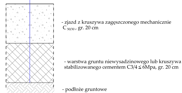
KONSTRUKCJA NAWIERZCHNI ul.11 Listopada - zjazd z kruszywa zagęszczonego mechanicznie krawężnikiem projektowanym a granicą pasa drogowego)
