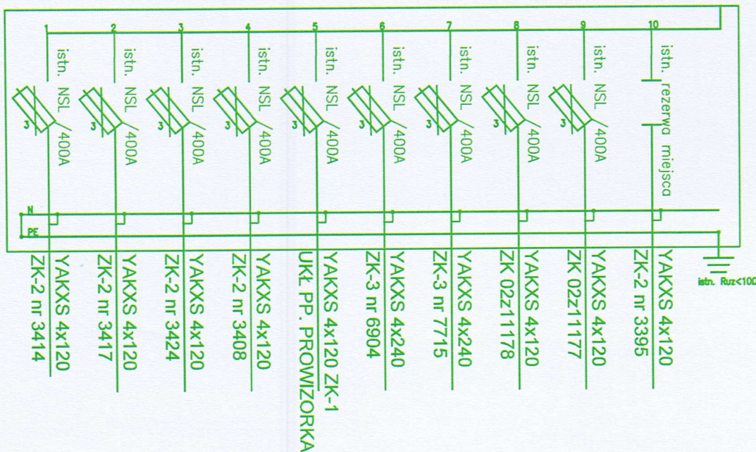
istn. rozdzielnica nN ST 1653 (układ sieci TN)
