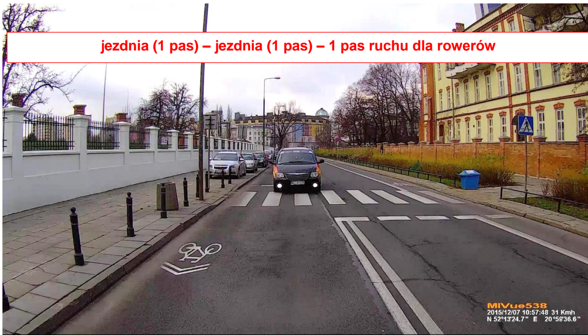
Rys. 2.17 Elementy przekroju poprzecznego – przykład IV.
