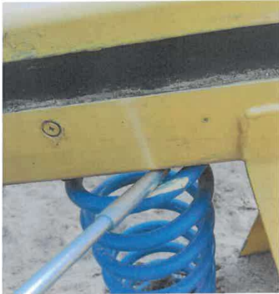
Zgniecenie w zwojach sprężyny, Należy podjąć działania naprawcze.
