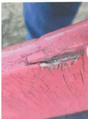
Ślady próchnicy materiału. Bez wpływu na bezpieczeństwo użytkownika
