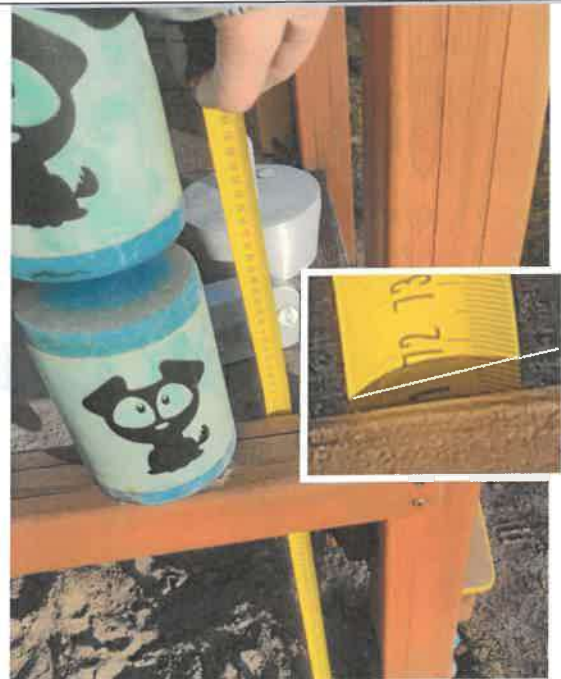
Zakleszczenie pomiędzy wałkami. Należy podjąć działania naprawcze
