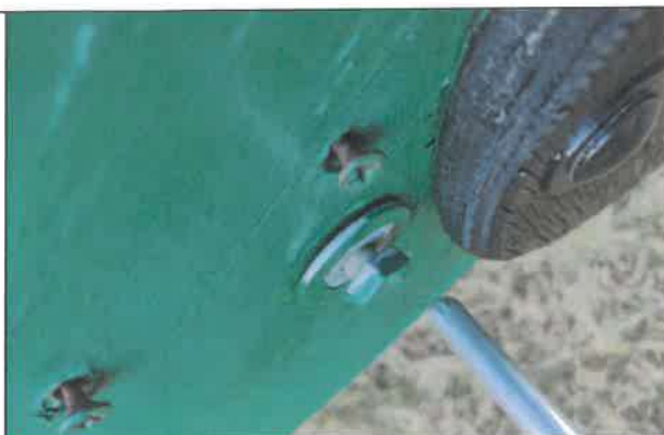
Wystające wkręty i niedokręcone śruby. Należy podjąć działania naprawcze
