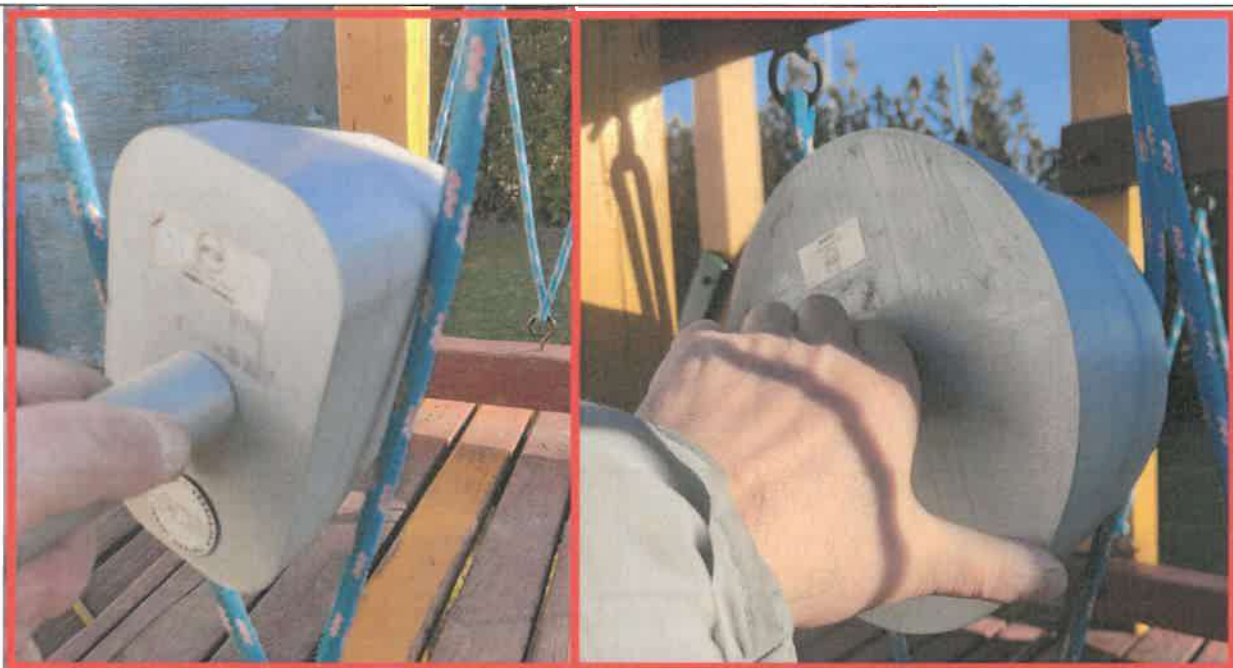
Zakleszczenie w balustradzie. Należy podjąć działania naprawcze
