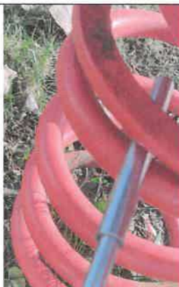
Zgniecenie w zwojach sprężyny. Należy podjąć działania naprawcze
